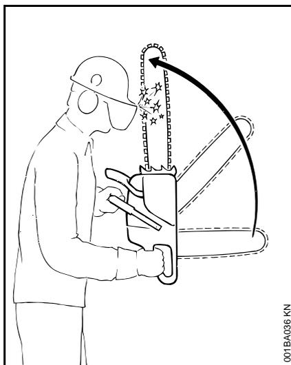
Bei einem Rückschlag (Kickback) wird die Säge plötzlich und unkontrollierbar zum Benutzer geschleudert.
