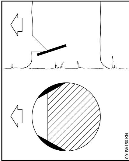
Splintschnitte verhindern bei langfaserigen Hölzern das Aufreißen des Splintholzes beim Fallen des Stammes – an beiden Seiten des Stammes auf Höhe der Fallkerbsohle etwa  $1/10$  des Stammdurchmessers – bei dickeren Stämmen höchstens bis Breite der Führungsschiene – einsägen.
