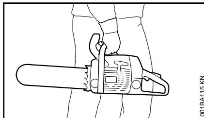
Motorsäge nur am Griffrohr tragen – heißer Schalldämpfer vom Körper weg, Führungsschiene nach hinten. Heiße Maschinenteile, insbesondere die Schalldämpferoberfläche, nicht berühren – Verbrennungsgefahr!
