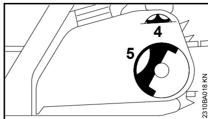
Beim Ansetzen des Kettenraddeckels müssen die Zähne von Spannrade und Spannscheibe ineinander greifen, ggf.
