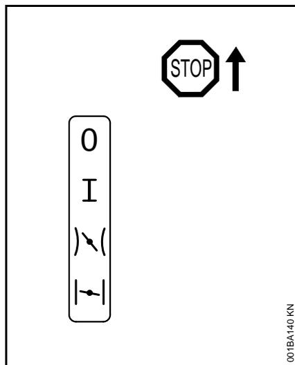
**Stop 0** – Motor aus – Zündung ist ausgeschaltet
