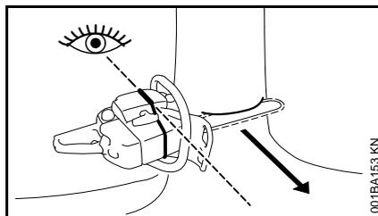
Diese Motorsäge ist mit einer Fällleiste an Haube und Lüftergehäuse versehen. Diese Fällleiste verwenden.
